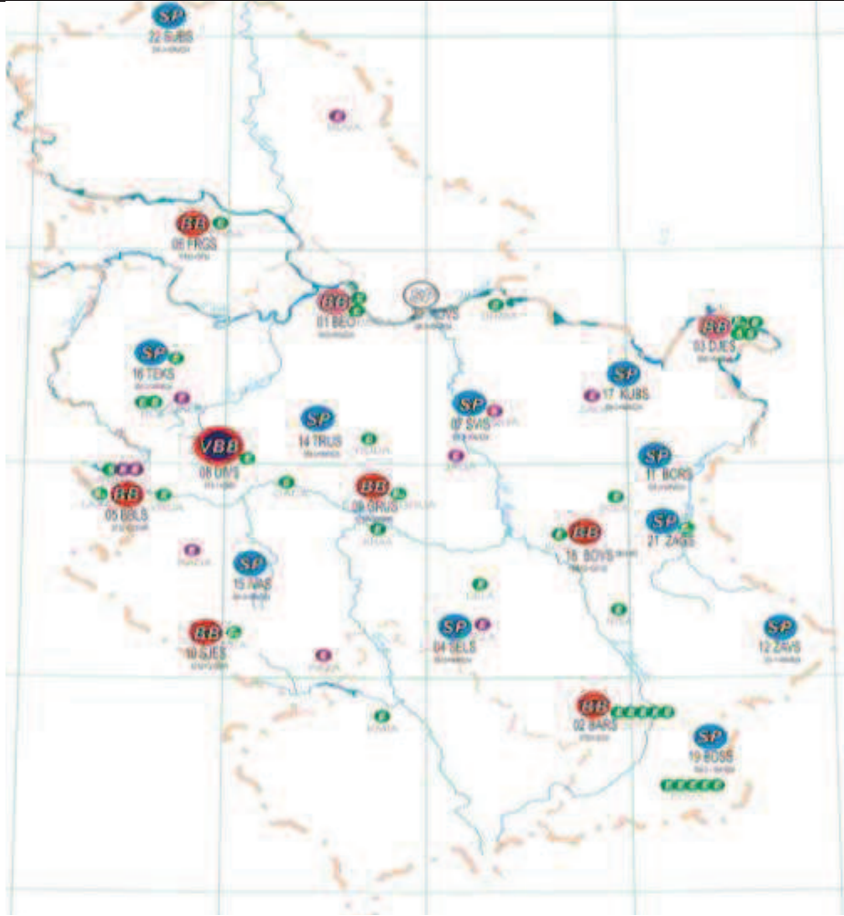
Слика.број 13. Просторни распоред сеизмолошких и акцелерометарских мерних места.
